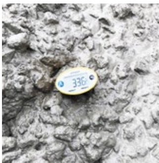
Temperatura del Hormigón
