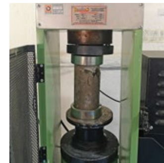
Resistencia a la Compresión
